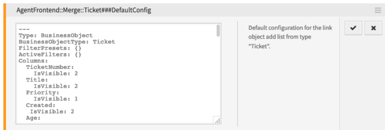
48. ábra: YAML értékkel rendelkező rendszerbeállítás
